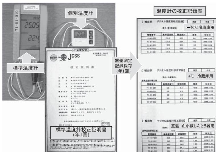
図1 標準温度計および個別温度計の校正記録表
