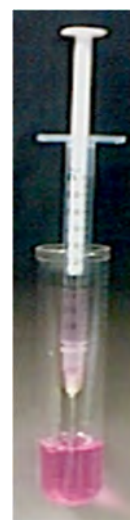
C. 管壁に触れ無いうように 2～3 回シリンジを引き、正確に 1.1mL を採取する。
